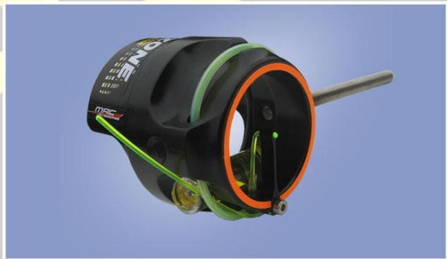
Su terminación global con anodizado en negro mate, previene de los molestos reflejos, el material de construcción es aluminio mecanizado con los máximos niveles de precisión, está concebido para uso indistinto de diestro y zurdo, con eje roscado de 5mm.
